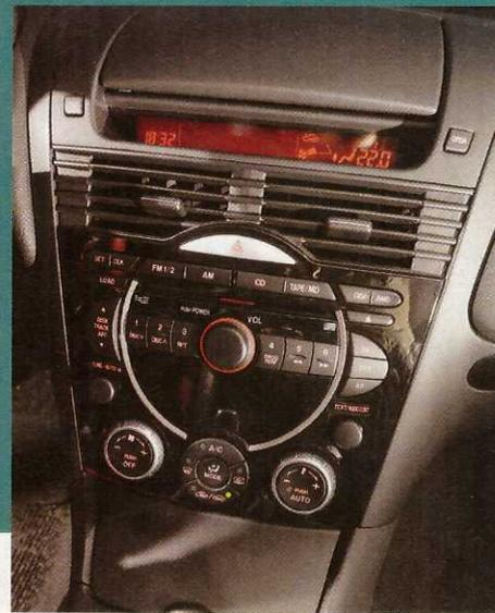
Die Mittelkonsole bietet Schalter für alles Notwendige. Oben am Bildrand: per Tastendruck ausklappbarer Monitor fürs Navi
