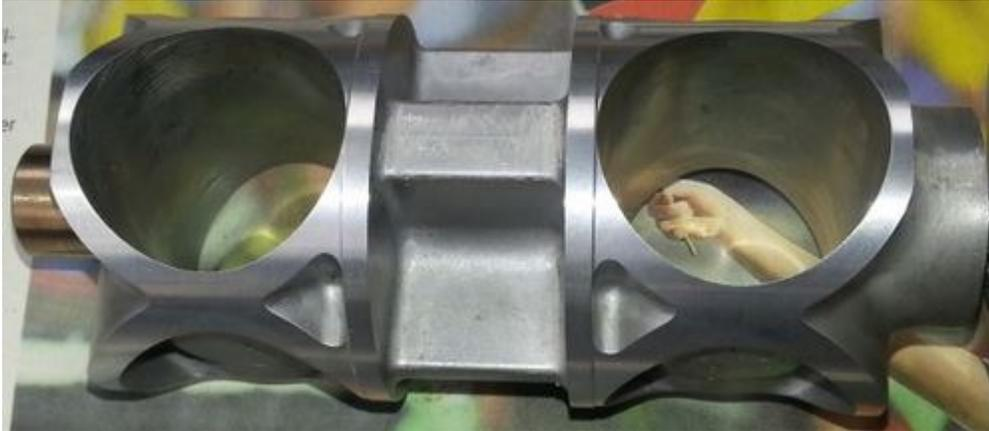
Das [SSV](#) ist ein zylinderförmiges Ventil das im Ansaugkrümmer sitzt.
