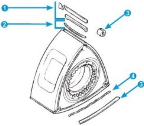
Zudem verfügt der Rotor über Öldichtungen die verhindern, dass Öl aus dem Rotorinneren und der Schmierung in die Brennkammer gerät.
