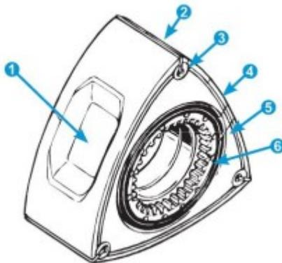
Der ca. 5,44Kg schwere Rotor besteht aus gegossenem Stahl und ist innen hohl, um das Gewicht zu reduzieren und eine Kühlung zu ermöglichen.
