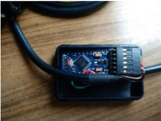
Das hält so schon gut, wenn man sicher gehen möchte kann man die Kabel jeweils 180° umschlagen und mit 2 Kabelbinden das Gehäuse und Kabel fixieren, damit hat man auch eine Zugentlastung.
